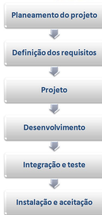
Figura 4.1: Seis fases do ciclo de vida do desenvolvimento de aplicações. Adaptado de [9].
