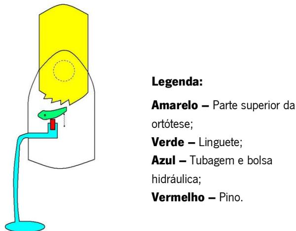
**Figura 36: Constituição do mecanismo de bloqueio por linguete [adaptado de 4].**
