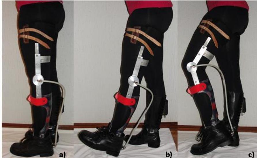
**Figura 56: Experimentação da ortótese: a) Posição vertical; b) Posição de dorsiflexão; c) Posição de plantiflexão.**
