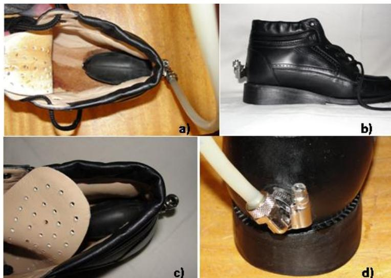
**Figura 54: Adaptação de um sapato à ortótese: a) Posição da bolsa dentro do sapato; b) Vista lateral do sapato, com o joelho hidrúlico; c) Colocação de uma palmilha por cima da bolsa; d) Montagem exterior do sapato com o joelho a 90° e tubo linear, e braçadeira entre o joelho a 90° e a bolsa.**
