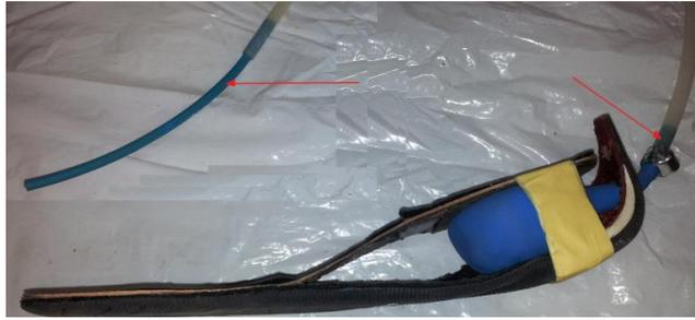
**Figura 53: Primeiro protótipo do sistema de atuação [adaptado de 4].**
