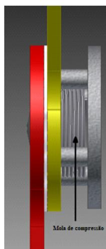
**Figura 38: Representação esquemática da posição da mola de compressão, no momento do êmbolo recuado (falta a representação do componente 6 na imagem) [adaptado de 4].**
