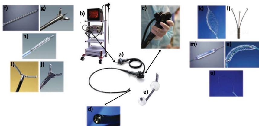
Figura 1.7 a) Endoscópio flexível standard ; b) Torre endoscópica; c) Manípulo de controlo; d) Ponta do instrumento; e) Enteroscópio duplo balão; f) Agulha para biópsia; g) Pinça para biópsia; h) Escova de citologia; i) Pinça de apreensão, tipo dente de rato; j) Pinça de apreensão, tipo jacaré; k) Rede; l) Pinça tridente para apreensão; m) Balão dilatador; n) Stent de metal; o) Alça de polipectomia [11].
