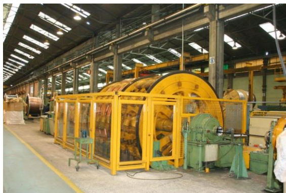
Figura 18 – Aplicação de Ecrã Metálico
