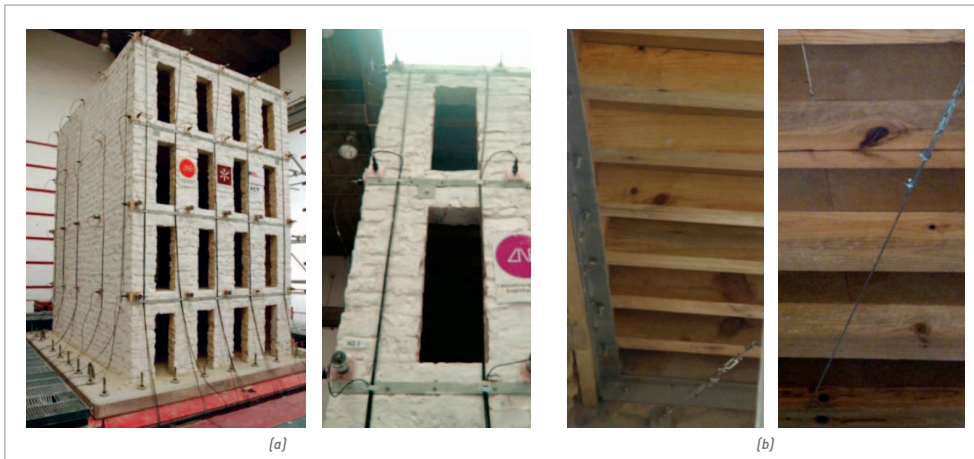
> Figura 2: Modelo reforçado: (a) vista geral; (b) pormenores do reforço.
