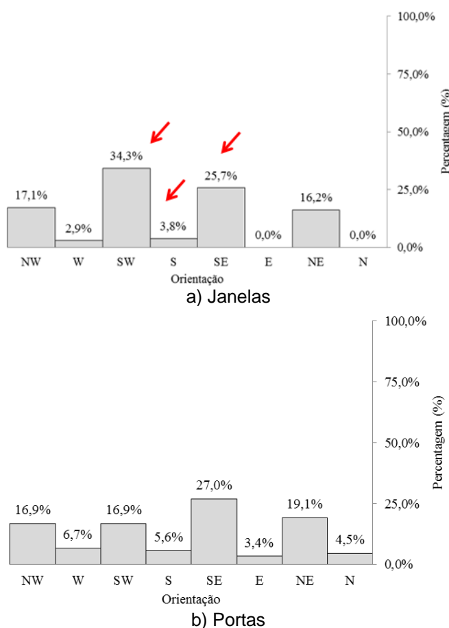
Figura 2. Distribuição da orientação dos vãos de porta e de janela de edifícios em xisto do Peso da Régua.
