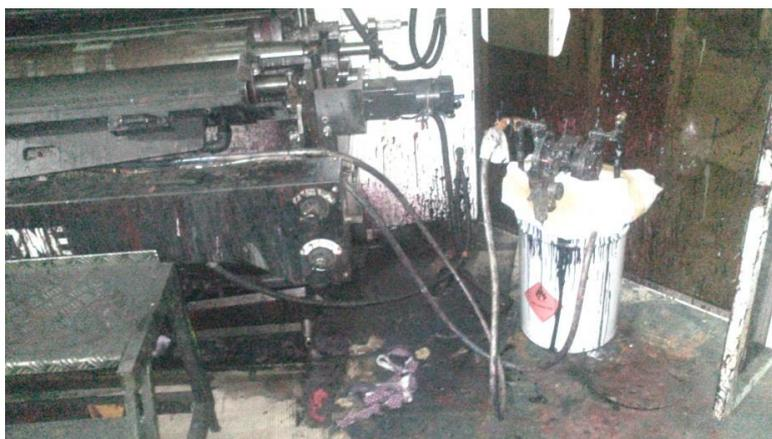
**Figura 20 – Lata de tinta com batedor para a Fle4**
