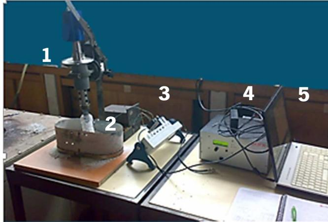
**Figura 3.11:** Esquema representativo dos diversos equipamentos utilizados no ensaio um. (1) Dispositivo de US (2) Moldação cerâmica (3) Equipamento de aquisição de temperaturas (4) Gerador acústico (5) PC com o *software Labview 7.1 Professional Development System*.
