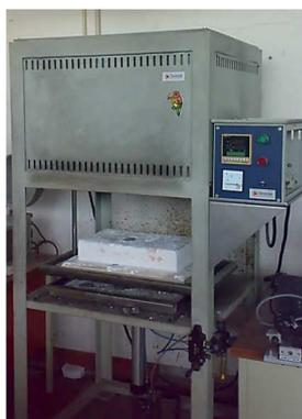
**Figura 3.6:** Mufla no qual foi realizado as operações de descirificação e sinterização.
