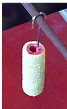
**Figura 3.5:** Suspensão do modelo de cera para a realização da operação de secagem.
