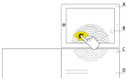
Figura 2: A - Tablet; B - Localização aproximada do sensor; C - Íman embebido; D - Livro impresso.
