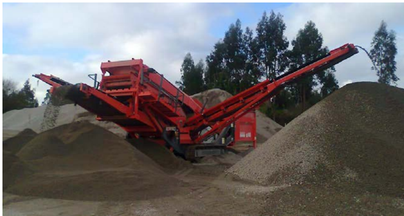
Fig. 2. Classificador utilizado para separação do MF em duas frações
