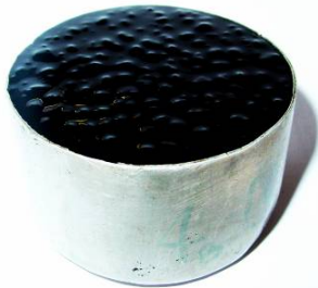
Fig. 2. Aspecto heterogêneo do betume modificado com SBS granulado (má digestão no betume)
