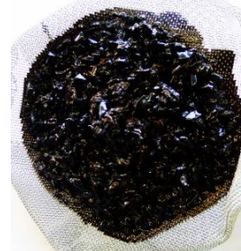
Fig. 3. Partículas de ABS granulado não digeridas no betume após filtragem do betume modificado
