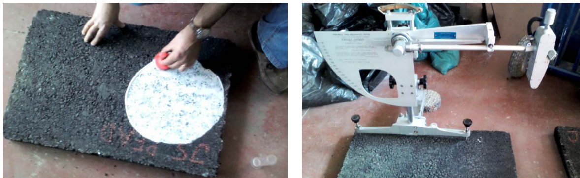
Fig.4. Ensaio da mancha de areia e pêndulo britânico
