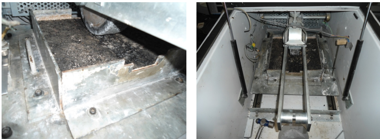
Fig.2. Ensaio de pista ou Wheel Tracking Test
