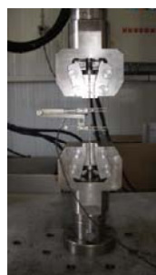
Fig. 8: Configuração do ensaio de tração
