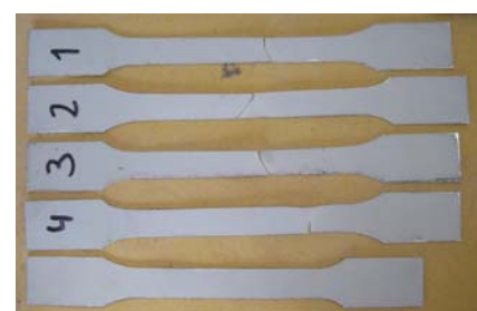
Fig. 9: Provetes testados após rotura
