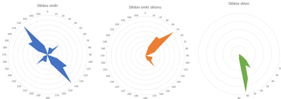
Obrázek 62: Grafy zobrazující směry průběhu, směr sklonu a sklon zlomových systémů na naměřené lokalitě Dědov. (Zdroj: vlastní měření)
