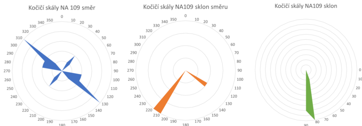
Obrázek 44: Grafy zobrazující směry průběhu, směr sklonu a sklon zlomových systémů na naměřené lokalitě Kočičí skály NA109. (Zdroj: vlastní měření)
