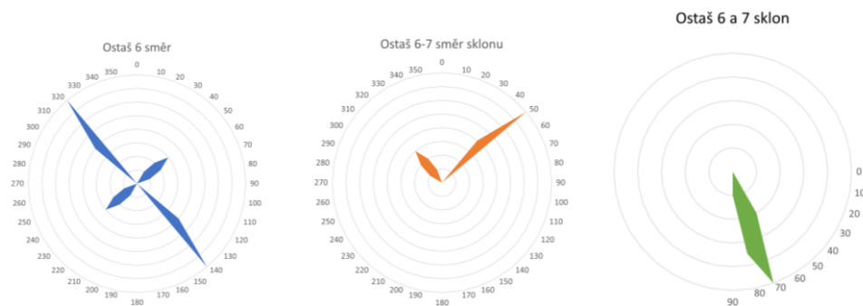
Obrázek 33: Grafy zobrazující směry průběhu, směr sklonu a sklon zlomových systémů na naměřené lokalitě Ostaš 6. (Zdroj: vlastní měření)
