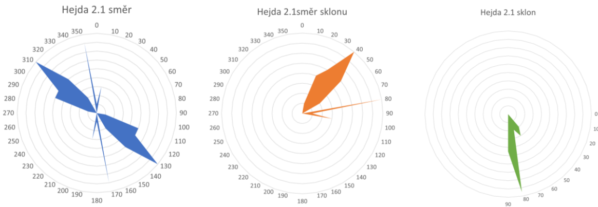
Obrázek 57: Grafy zobrazující směry průběhu, směr sklonu a sklon zlomových systémů na naměřené lokalitě Hejda 2.1. (Zdroj: vlastní měření)
