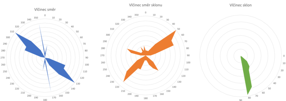
Obrázek 65: Grafy zobrazující směry průběhu, směr sklonu a sklon zlomových systémů na naměřené lokalitě Vlčinec. (Zdroj: vlastní měření)
