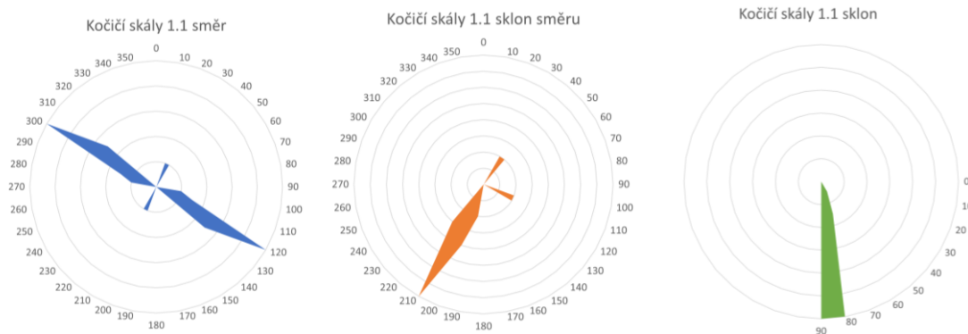
Obrázek 42: Grafy zobrazující směry průběhu, směr sklonu a sklon zlomových systémů na naměřené lokalitě Kočičí skály 1.1. (Zdroj: vlastní měření)
