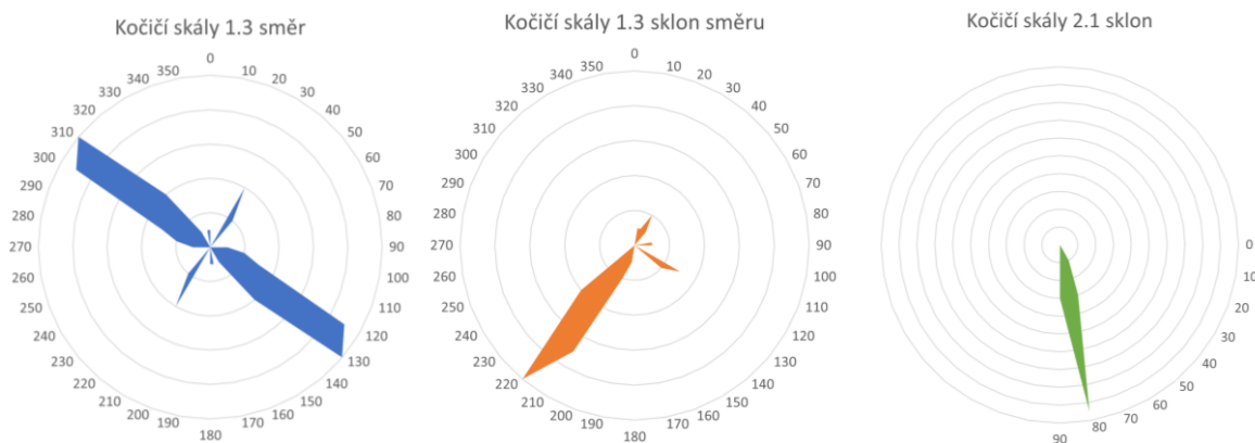
Obrázek 46: Grafy zobrazující směry průběhu, směr sklonu a sklon zlomových systémů na naměřené lokalitě Kočičí skály 1.3. (Zdroj: vlastní měření)
