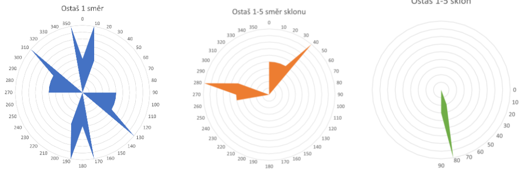
Obrázek 32: Grafy zobrazující směry průběhu, směr sklonu a sklon zlomových systémů na naměřené lokalitě Ostaš 1. (Zdroj: vlastní měření)
