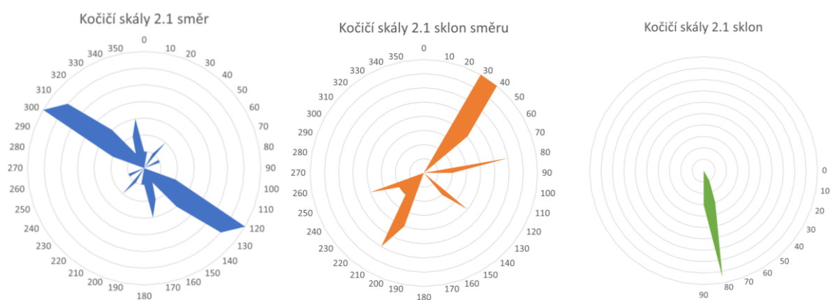
Obrázek 47: Grafy zobrazující směry průběhu, směr sklonu a sklon zlomových systémů na naměřené lokalitě Kočičí skály 2.1. (Zdroj: vlastní měření)
