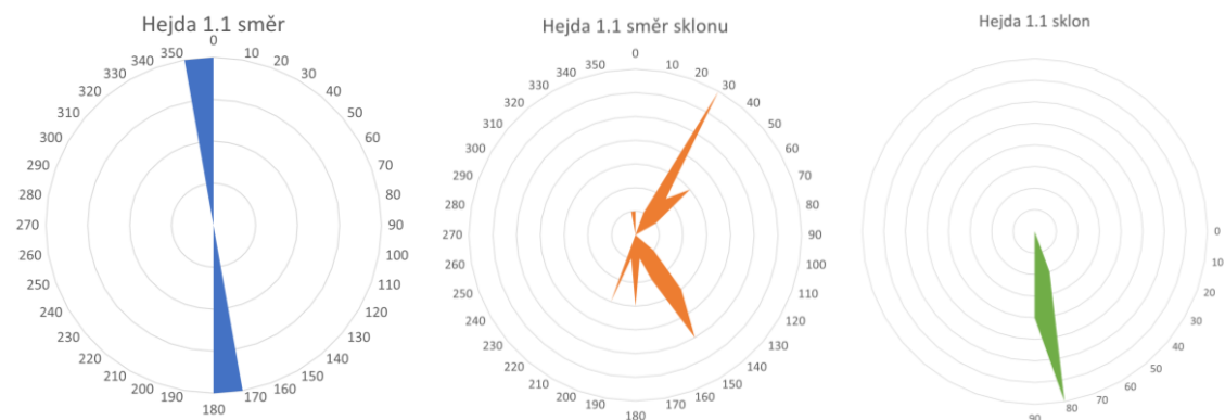
Obrázek 55: Grafy zobrazující směry průběhu, směr sklonu a sklon zlomových systémů na naměřené lokalitě Hejda 1.1. (Zdroj: vlastní měření)
