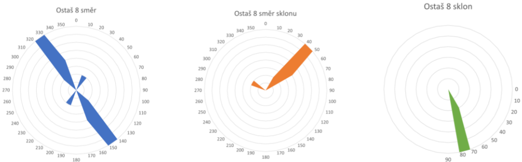
Obrázek 34: Grafy zobrazující směry průběhu, směr sklonu a sklon zlomových systémů na naměřené lokalitě Ostaš 8. (Zdroj: vlastní měření)
