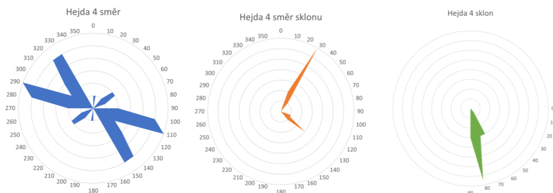
Obrázek 60: Grafy zobrazující směry průběhu, směr sklonu a sklon zlomových systémů na naměřené lokalitě Hejda 4. (Zdroj: vlastní měření)
