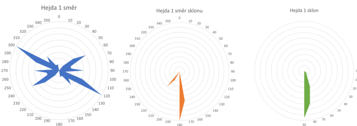
Obrázek 54: Grafy zobrazující směry průběhu, směr sklonu a sklon zlomových systémů na naměřené lokalitě Hejda 1. (Zdroj: vlastní měření)
