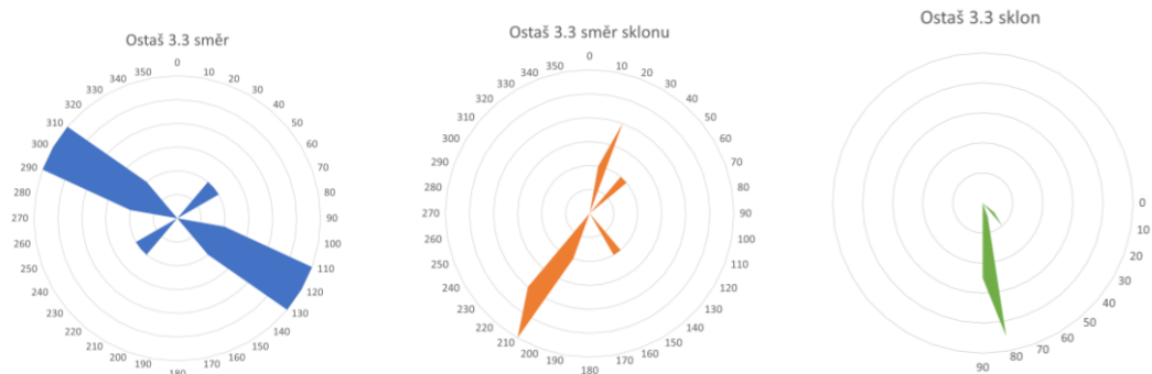
Obrázek 39: Grafy zobrazující směry průběhu, směr sklonu a sklon zlomových systémů na naměřené lokalitě Ostaš 3.3. (Zdroj: vlastní měření)
