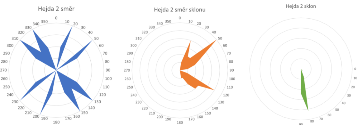
Obrázek 56: Grafy zobrazující směry průběhu, směr sklonu a sklon zlomových systémů na naměřené lokalitě Hejda 2. (Zdroj: vlastní měření)
