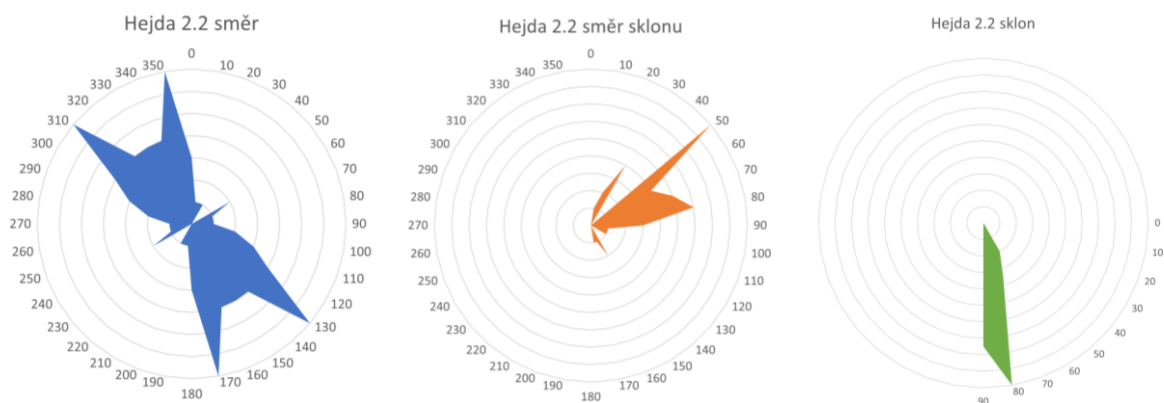
Obrázek 58: Grafy zobrazující směry průběhu, směr sklonu a sklon zlomových systémů na naměřené lokalitě Hejda 2.2. (Zdroj: vlastní měření)
