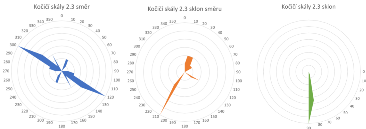
Obrázek 49: Grafy zobrazující směry průběhu, směr sklonu a sklon zlomových systémů na naměřené lokalitě Kočičí skály 2.3. (Zdroj: vlastní měření)
