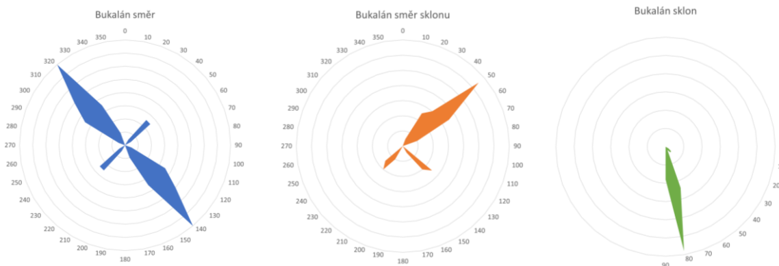
Obrázek 63: Grafy zobrazující směry průběhu, směr sklonu a sklon zlomových systémů na naměřené lokalitě Bukalán. (Zdroj: vlastní měření)
