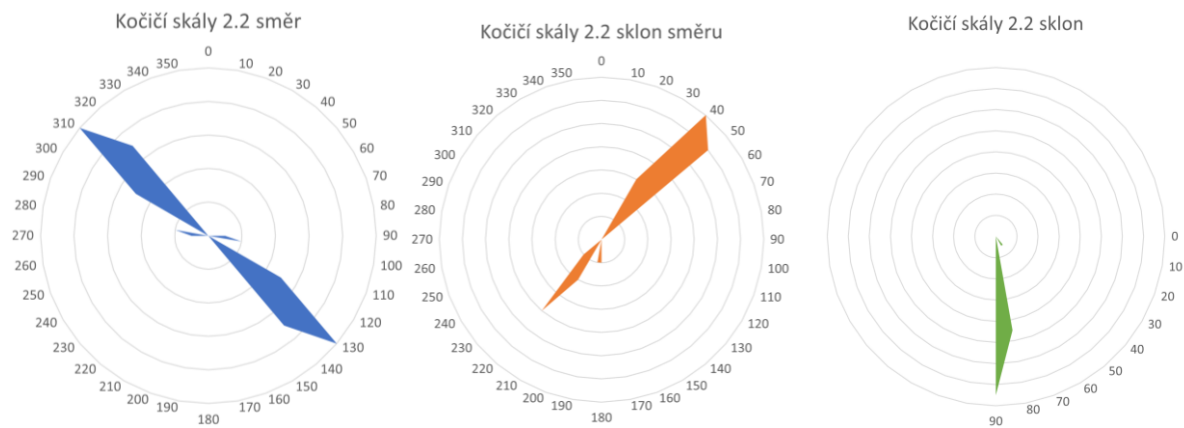
Obrázek 48: Grafy zobrazující směry průběhu, směr sklonu a sklon zlomových systémů na naměřené lokalitě Kočičí skály 2.2. (Zdroj: vlastní měření)
