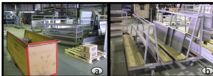
Figura 29 – Carrinhos de transporte de materiais e subconjuntos a) diversos componentes; b) chapas quinadas
