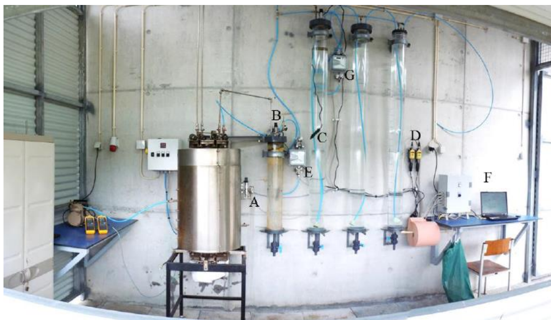
Figura 1. Fotografia a 360 ° da instalação piloto. A – Medidor de pressão no interior do reator, B – Medidor de pressão nas colunas, C – Medidor de pH no interior da coluna, D – Recetores de sinal dos medidores de pH, E – Caudalímetro da coluna de limpeza do gás de síntese, F – Controlador de dados e G – Caudalímetro da primeira coluna de fixação.
