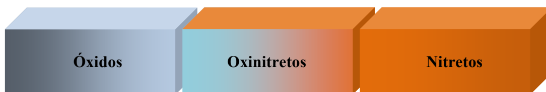
Figura 1 – Os oxinitretos de metal ( \text{MeN}_x\text{O}_y ) são uma classe de materiais versátil, uma vez que abrem a possibilidade de obter um largo gradiente de diferentes propriedades incluídas entre as do óxido ( \text{MeO}_y ) e as do nitreto ( \text{MeN}_x ) do mesmo metal.
