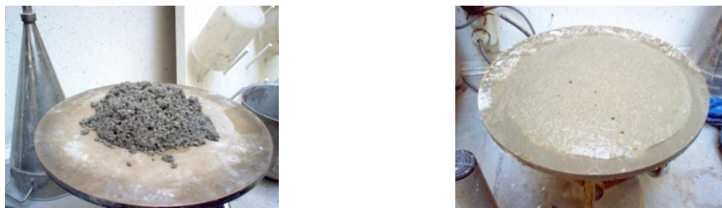
Figura 6.14 - Espalhamento de algumas argamassas para a mesma razão A/C .
