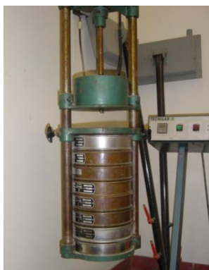
Figura 6.1 - Agitador mecânico da coluna de peneiros.
