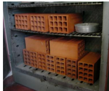
b) Estufa para a secagem dos provetes.
