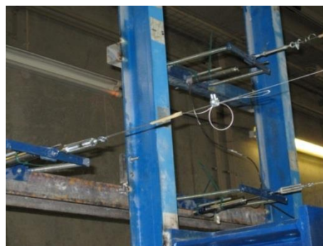
b) Cabos de aço tensionados ligados ao sistema de aquisição de deslocamentos.
