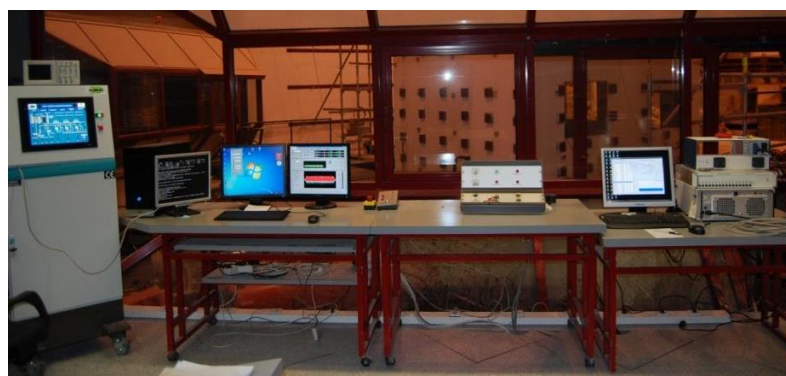
Figura 8.8 - Sala de controlo da mesa sísmica com equipamento de controlo da mesa e de aquisição da instrumentação.
