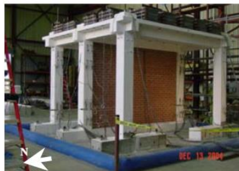
b) Estrutura na mesa sísmica.
