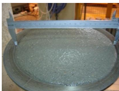
Figura 6.2 - Determinação da consistência das argamassas por espalhamento.
