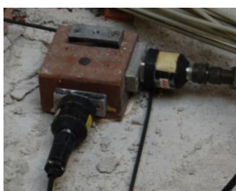
a) Acelerómetros nos cantos das lajes.
