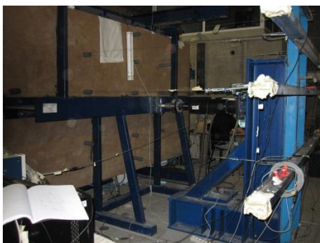
a) Suporte rígido para a instrumentação ligado ao referencial exterior.
