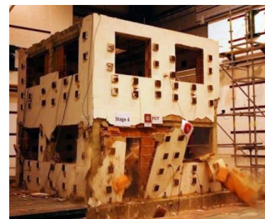
b) Início da expulsão para o exterior do pano entre aberturas do alçado Norte.
