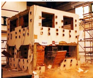
c) Expulsão para o exterior do pano entre aberturas do alçado Este.
