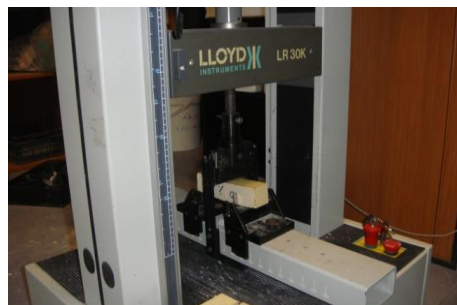
Figura 6.4 - Equipamento para a realização do ensaio de flexão.
