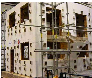
a) Expulsão para o exterior do pano entre aberturas do alçado Este.
