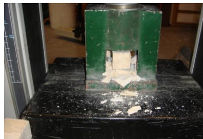
Figura 6.5 - Equipamento para a realização do ensaio de compressão.
