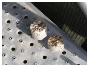
Figura 2-25 | exemplos de carotes extraídas
