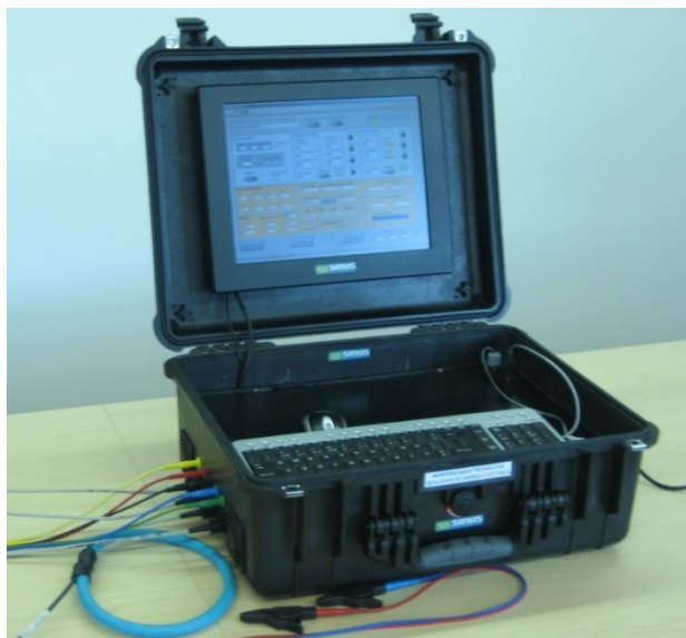
Figura 1 – Monitorizador de QEE desenvolvido pelo GEPE no Projeto SINUS (versão portátil).
