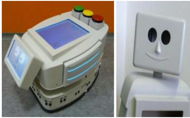
Figura 2.6 - Robô IROMEC na posição horizontal (figura à esquerda), sem a máscara, e na posição vertical com máscara (figura à direita) [27] .
