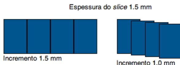
Figura 3.5: Ilustração de diferentes incrementos para a mesma espessura de *slice* (1.5 mm). À esquerda, o valor de incremento igual à espessura. À direita, o valor de incremento dos cortes é inferior (1 mm) à espessura, resultando na sobreposição das imagens.
