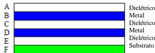
Figura 9 - Representação esquemática de um absorsor multicamadas [9].
