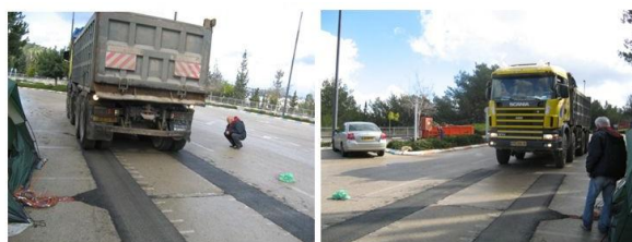
Figura 10 – Passagem do Camião sobre o Trecho Experimental (Innowattech, 2010)
