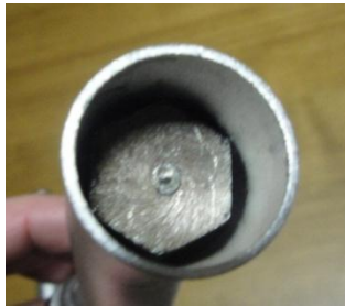
Figura 50 - Colocação de lastro no extensor
