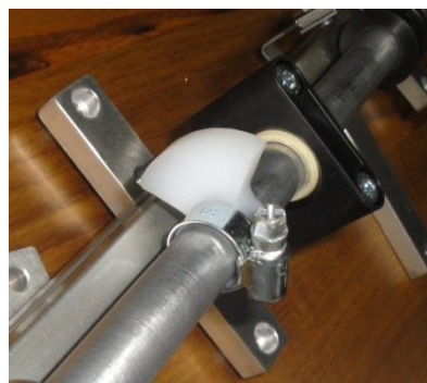
Figura 58 - Afinação do limitador movimento de rotação
