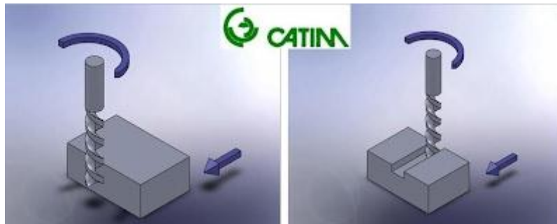
Figura 40- Representação do processo de fresagem
