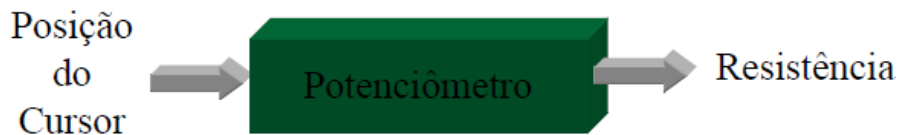
Figura 29 - Representação do funcionamento de um potenciômetro
