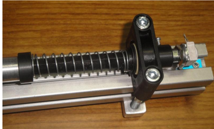
Figura 56 - Distância entre topo do tubo inox D16 e chumaceira igual a 40 mm
