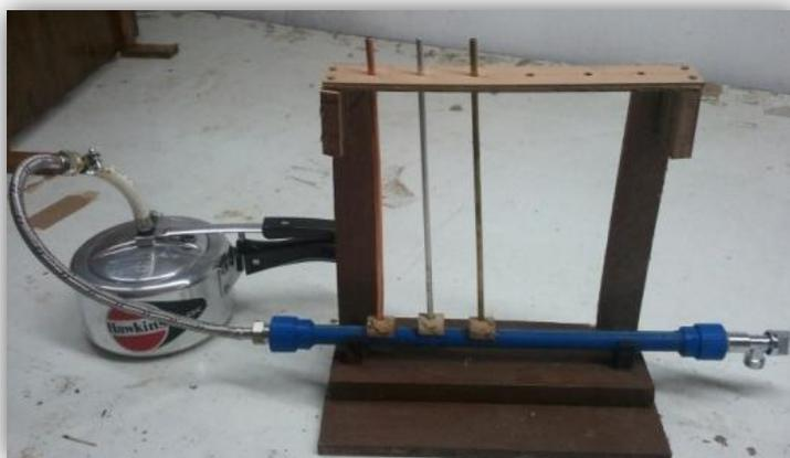
Figura 1.4. A- Protótipo da experiência: Condução
