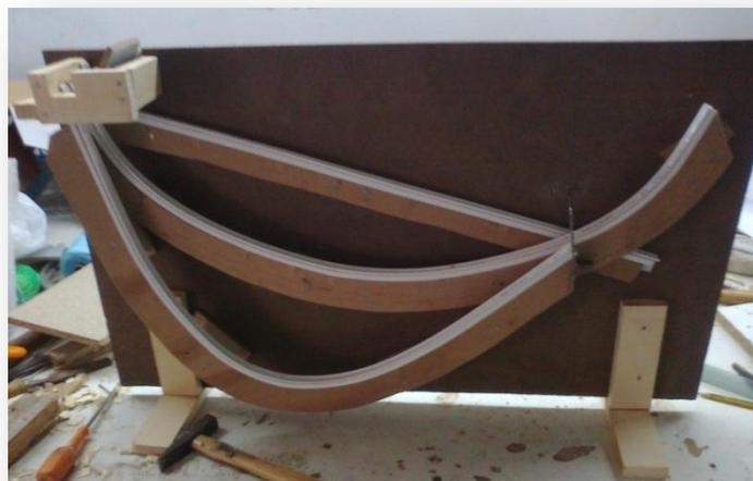
Figura 1.6.7. Construção do protótipo da braquistócrona.
