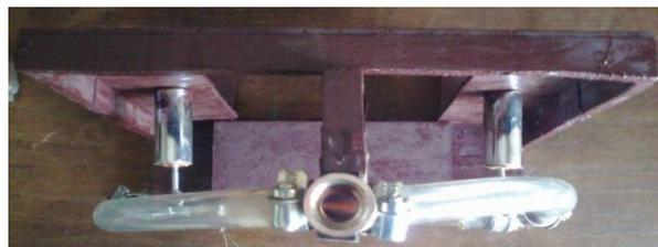
Base em madeira para colocar no protótipo, com a finalidade de elevar ligeiramente a lamparina de álcool
