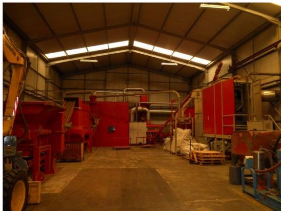
**Figura 32 – Linha de trituração de cabos e fios**
