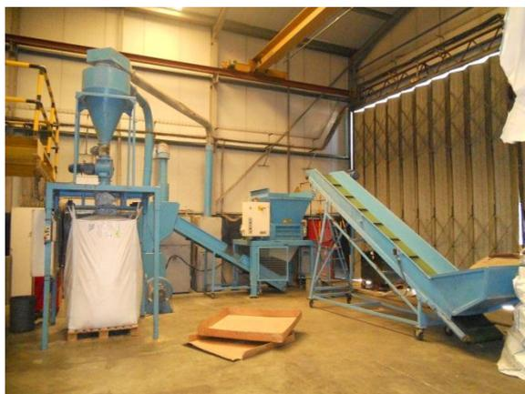
**Figura 33 - Pré-destroçador e triturador de purgas**
