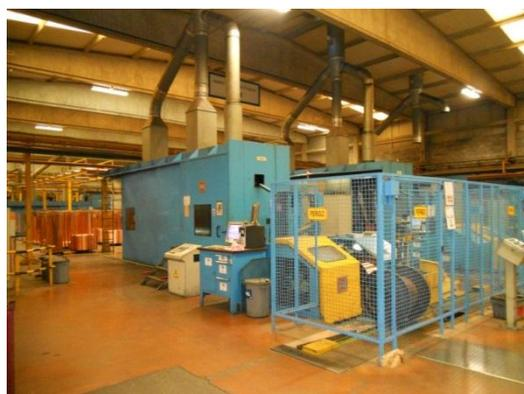
**Figura 18 – Trefiladora multifilar**
