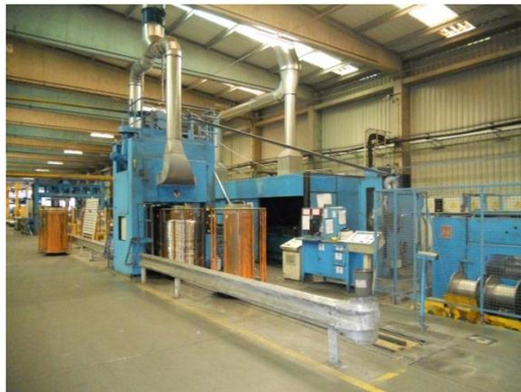
**Figura 27 – Trefiladora Unifilar de Alumínio**
