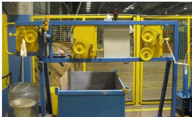
**Figura 22 – Descascador de fio**
