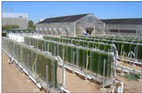
Ilustração 40- Conjunto de fotobiorreatores de placas planas [48].
