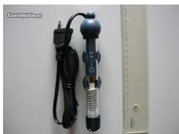
Ilustração 60- Ilustração da resistência de aquecimento da água do depósito
