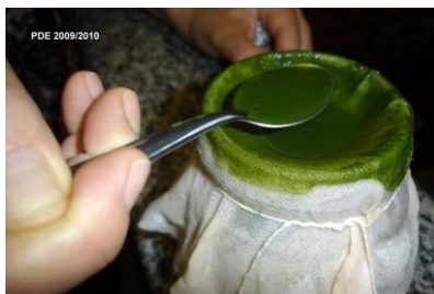
Ilustração 28- Processo de filtração do meio de cultura com microalgas [42].
