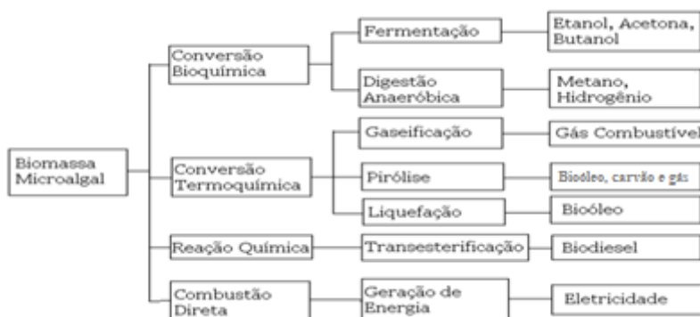
Ilustração 29- Diferentes formas de obtenção de energia através de biomassa [43].
