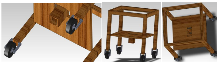
Ilustração 48- Desenho em Solidworks do suporte do depósito
