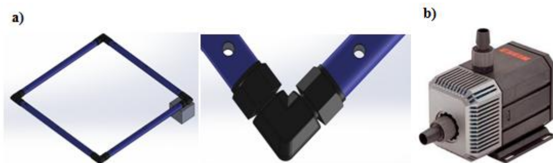
Ilustração 53 e 54- a) Desenho em Solidworks do sistema de agitação do meio; - b) Ilustração da bomba de circulação de água utilizada.
