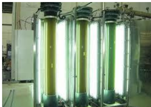
Ilustração 36- Fotobiorreator tubular vertical com iluminação artificial exterior [46].
