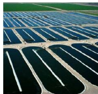
Ilustração 23 e 24- a) Esquema de uma pista Raceway; b) Fotografia de uma piscina Raceway para produção da espécie Spirulina, situada na empresa Earthrise Nutritionals, em Califórnia, Estados Unidos [36] .
