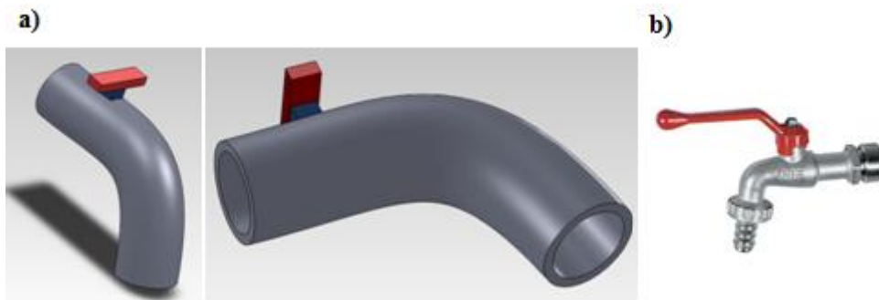
Ilustração 51 e 52- a) Duas ilustrações de desenhos em Solidworks da torneira de recolha de amostras; b) Ilustração da torneira escolhida.
