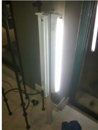
Ilustração 67- Veio central acoplado com as 4 lâmpadas T5
