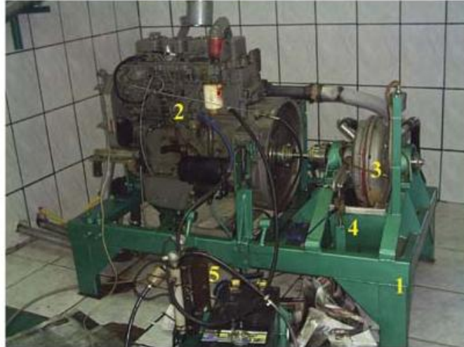
Motor adaptado à base do dinamômetro. 1 - suporte; 2 - motor; 3 - turbina hidráulica; 4 - célula de carga, e 5 - fluxômetro.
