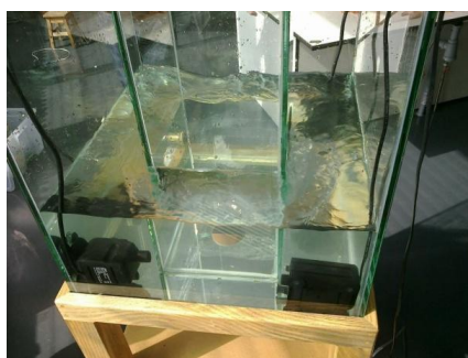
Ilustração 73- Colocação das bombas no depósito.
