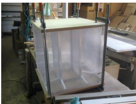
Ilustração 64- Montagem do depósito em acrílico.
