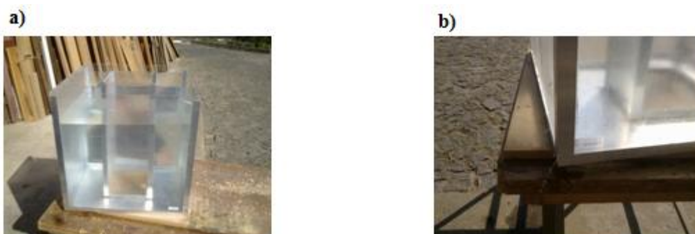
Ilustração 65 e 66- a) Teste à vedação do depósito; b) Cedência do depósito.
