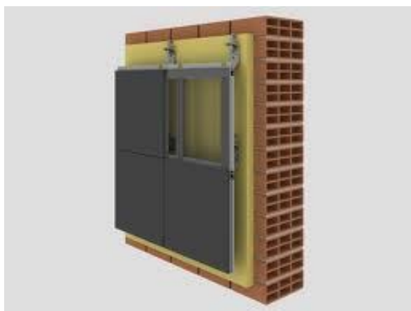
Fig. 67 Aplicação de fachada ventilada, com revestimento de painéis fenólicos (Matimex, 2011)
