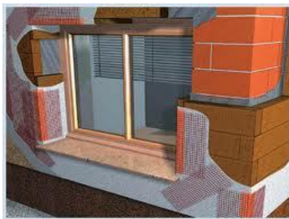
Fig. 65 Aplicação de sistema ETICS por cima do revestimento existente (Fafisol, 2008)
