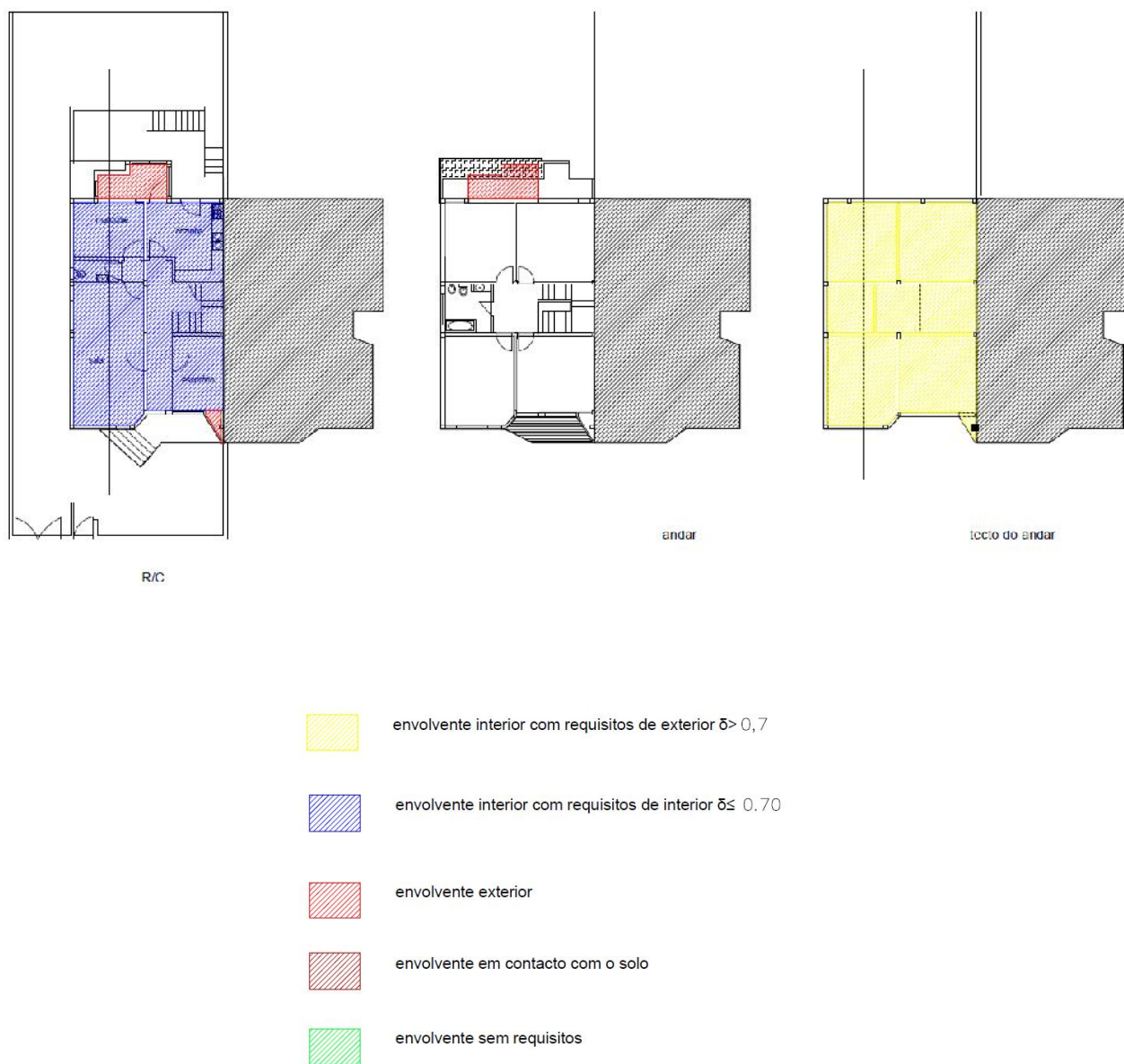
Fig.181 Marcação das envolventes no edifício de Ferreiros
