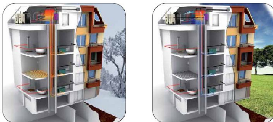
Exemplo de uma aplicação no inverno e no verão, utilizando piso radiante e ventiloconvectores.
