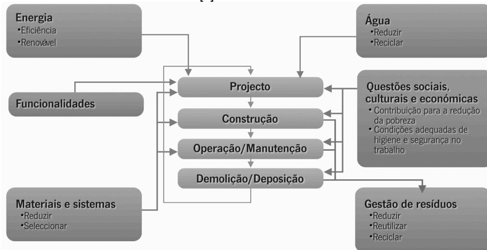
Figura 2. Abordagem integrada e sustentável às fases do ciclo de vida de uma construção [11].
