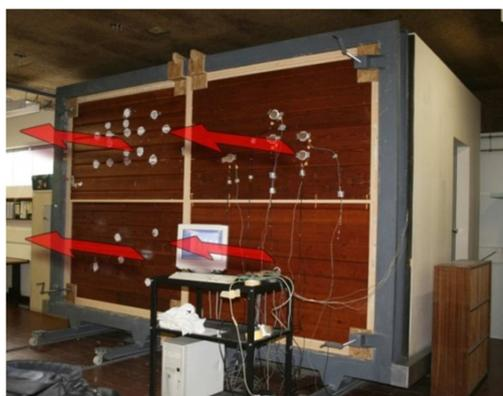
Figura 1. Provetes de teste com o equipamento de medição colocado e com a indicação do fluxo de calor considerado.
