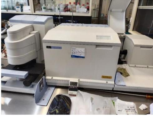
Espectrómetro De Transformada De Fourier
