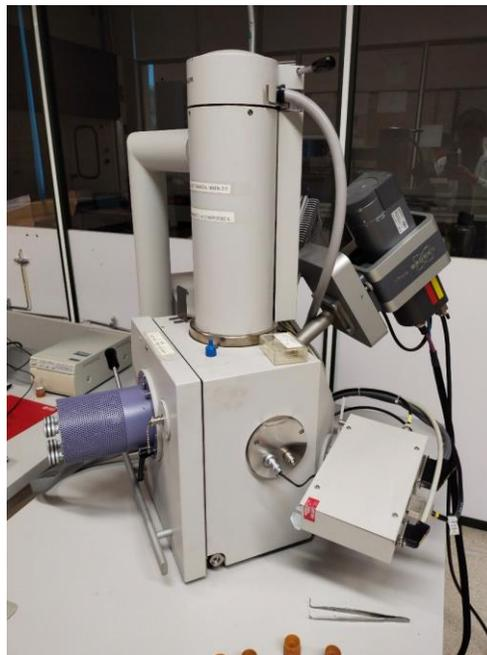
Microscopio Electrónico de Barrido
