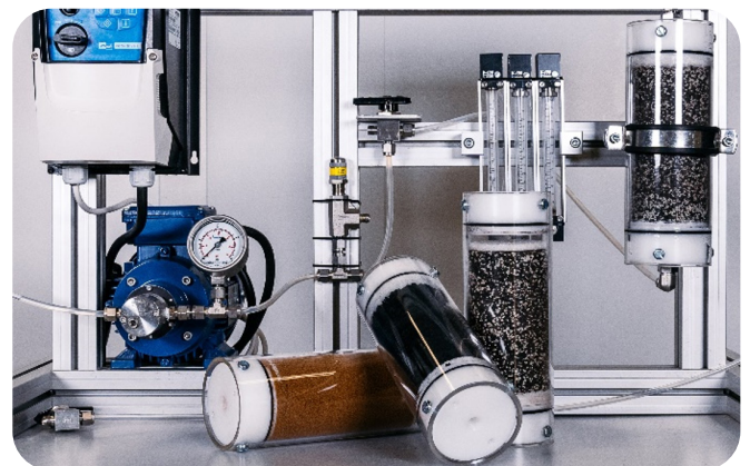
Labortest zur Bestimmung des Stoffrückhalts von Pflanz- und Adsorbersubstraten. ©Burkhardt
