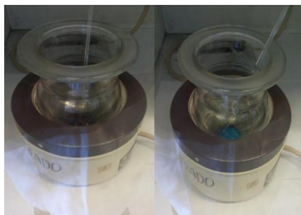
Figura 13. Reactor empleado para contener la mezcla de los reactivos.
