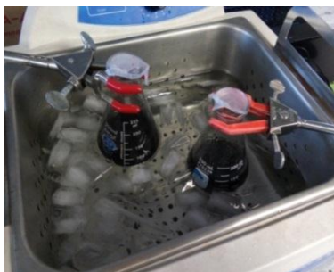
Figura 10. Baño de ultrasonido con las disoluciones de los precursores metálicos a 4 °C, para adicionar borohidruro de sodio.
