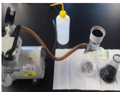
Figura 11. Lavado y filtrado de los electrocatalizadores obtenidos durante la síntesis.
