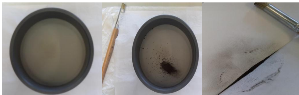
Figura 16. Tamiz, tamizado y electrocatalizador.
