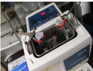
Figura 7. Dispersión de los precursores metálicos y el óxido de grafeno en disolución haciendo uso del baño de ultrasonido.
