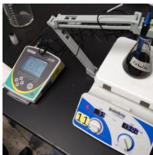
Figura 8. Medición de pH empleando NaOH.
