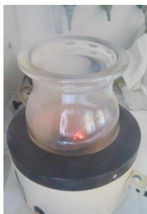
Figura 14. Reactor para la síntesis de combustión con los reactivos precursores de los electrocatalizadores y urea.
