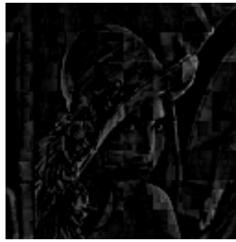
Figura 4.19: Píxeles no pintados en la imagen reconstruida de tamaño 512 \times 512 px con bd de 4 \times 4 px.
