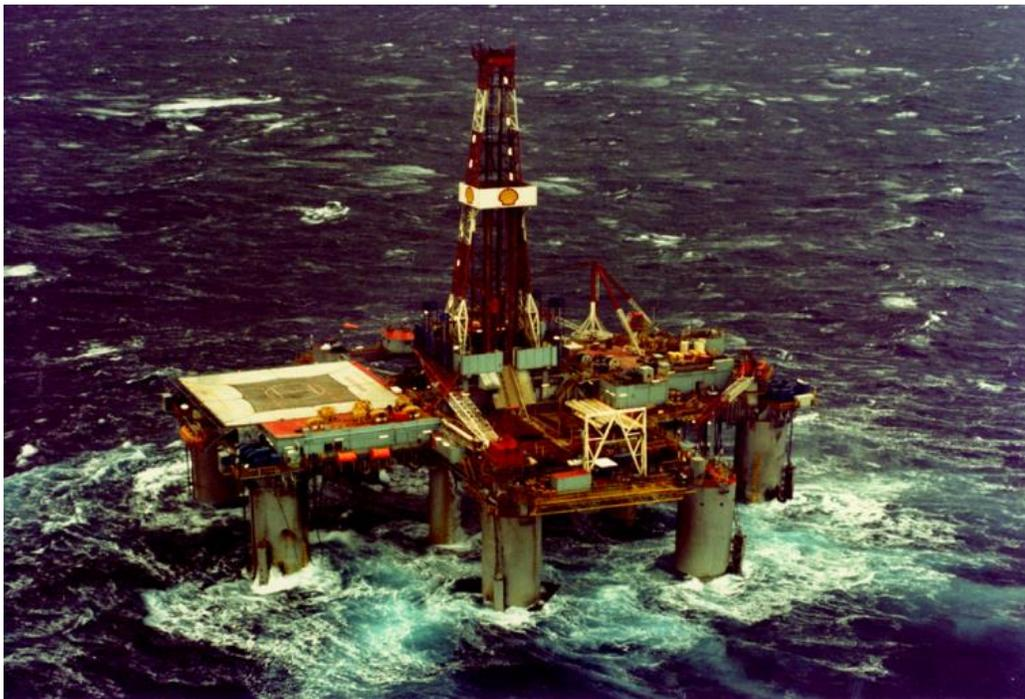
Figura 2.2 Semisumergible multi columna de la clase *Ocean Victory* de segunda generación
