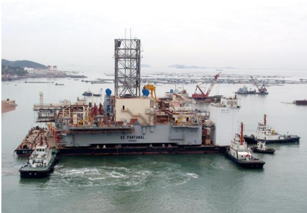
**Figura 1.7** Transportación de la superestructura de una Semisumergible (fuente: <http://web.cimc.com>).
