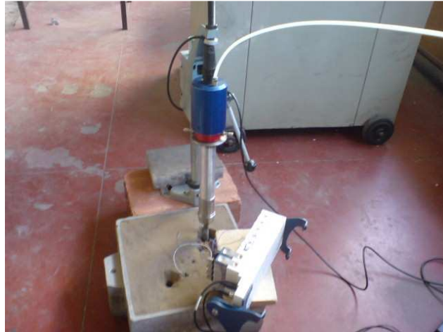
Figura 21 Vazamento da liga com recurso ao uso dos ultra-sons.
