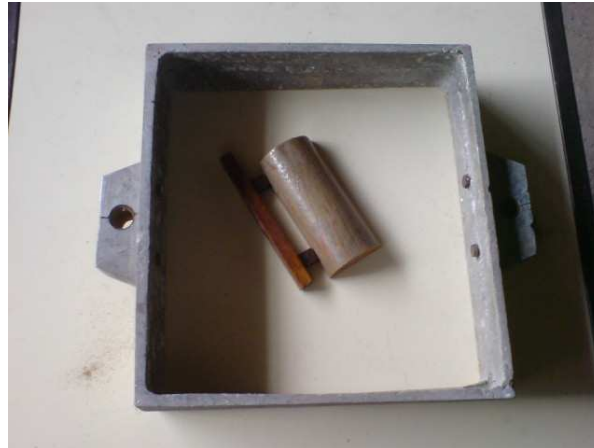
Figura 11 Meio molde inferior, canal de distribuição e ataque na meia caixa de moldação.
