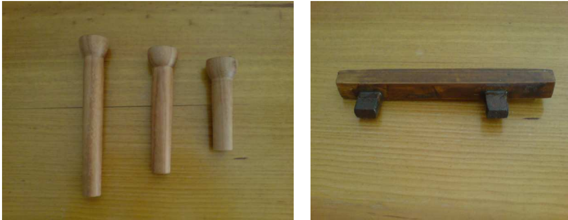
Figura 19 Canal de descida, canal de distribuição e dois canais de ataque.
