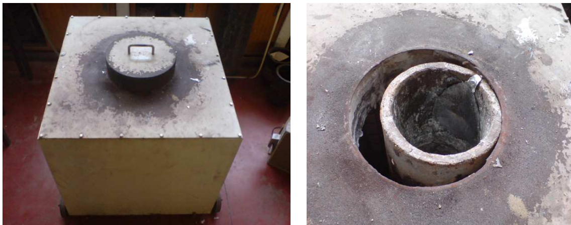
Figura 7 Forno de resistências e cadinho de carboneto de silício.
