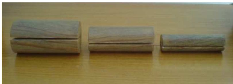
Figura 14 Imagem dos 3 moldes com diâmetros de 30,45 e 60 mm e com um comprimento de 130 mm.
