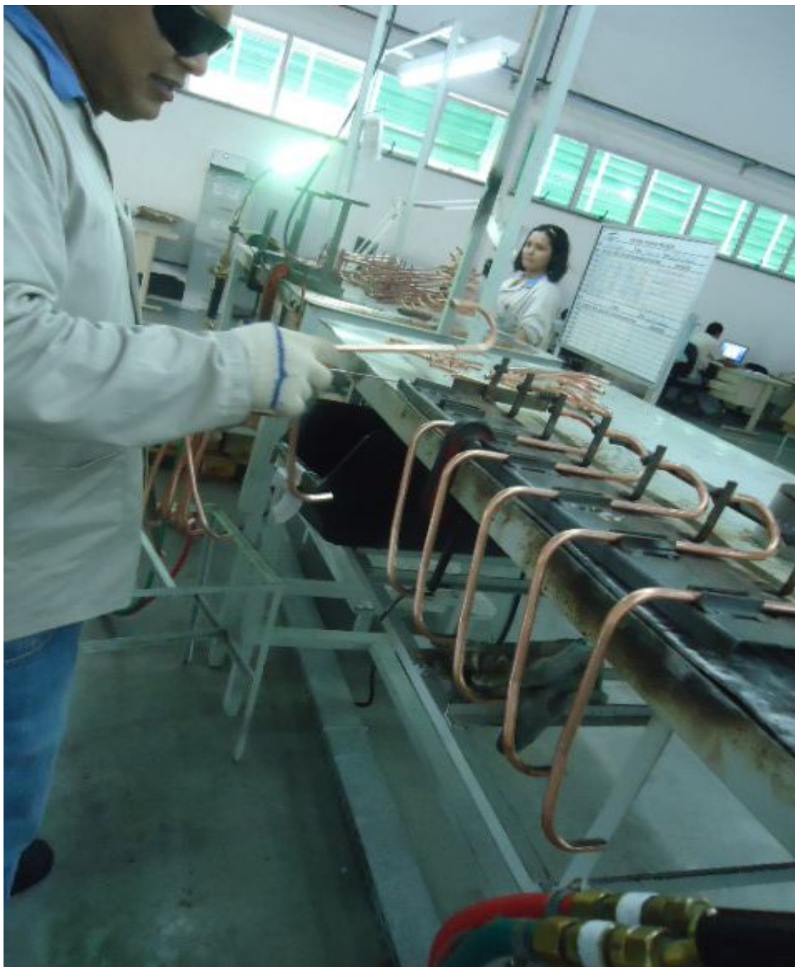
Figura 53 – Dispositivo de solda antes da melhoria
