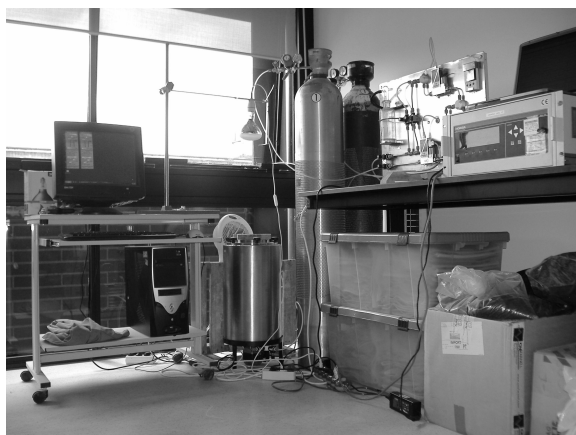
Figura 1 – Reator fotocatalítico desenvolvido durante este trabalho na Universidade de Aveiro.
