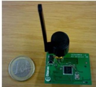
Figura 7. Módulo CC2530EM, da Texas Instruments [16].
