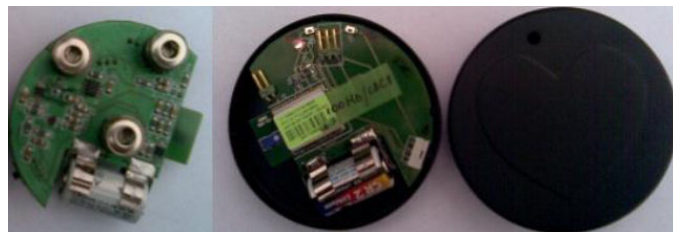
Figura 5. Protótipo do sensor de ECG e ritmo cardíaco.
