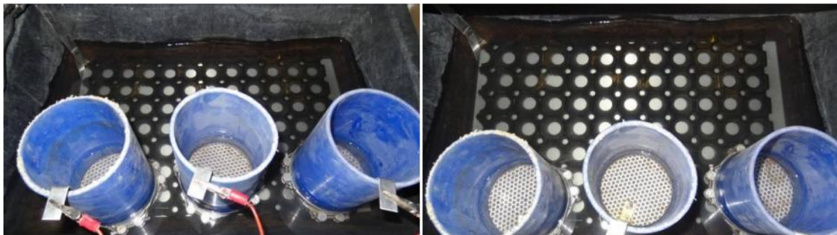
Figura 9. Ensaio de migração de cloretos de BSF em curso, após 6 horas (esquerda) e 24 horas (direita).
