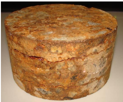
Figura 12. Macro-fissuração e destacamento do betão devido à corrosão das fibras de aço no BRFA após ensaio forçado de migração de cloretos.
