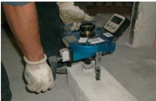
Figura 5. Execução do ensaio de pull-out
