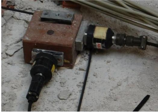
(a) Acelerómetros nos cantos das lajes
