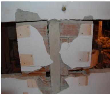
(a) Alvenaria segura apenas pela armadura de junta e conectores metálicos
