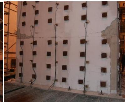
(c) Destacamento do reboco nas faces de vigas e pilares, essencialmente nos cantos
