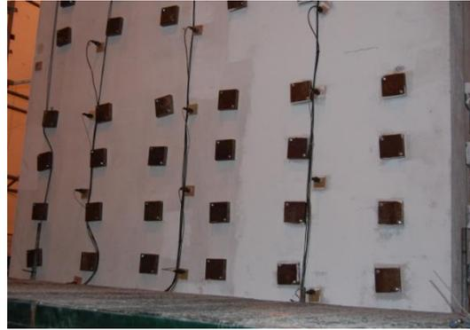
(b) Acelerómetros nas paredes de enchimento
