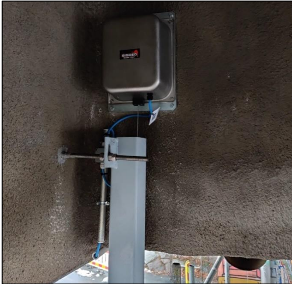
Kuva 31. SISGEO:n valmistama Wire crackmeter- siirtymäanturi kiinnitettynä Tuiranväylän sillan pääkannattimeen.
