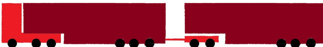
Kuva 8. Kuorma-auto, jonka päälle on kytketty puoliperävaunu, jonka perään on kytketty dolly, jonka päälle on kytketty puoliperävaunu.
