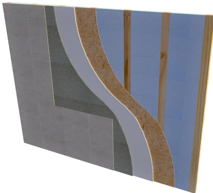
Figura 39 – Solução de parede interna entre ambiente seco e húmido
