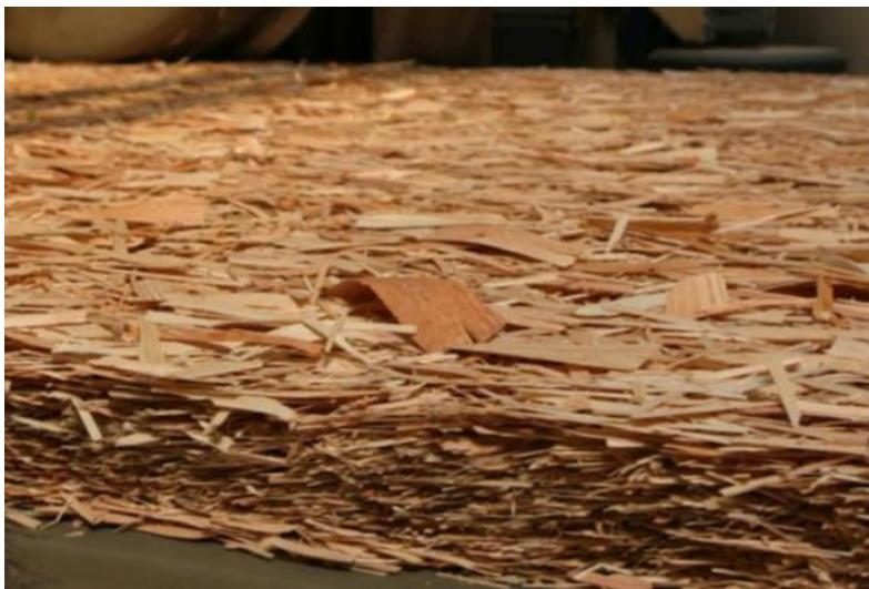
Figura 10 – Junção de lâminas de madeira para formação de painel OSB
