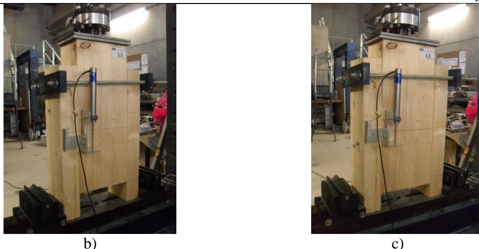
Figura 5 – a) Curva de resultados Força – deslocamento, b) Provete L_3 antes do ensaio e c) Provete L_3 depois do ensaio.
