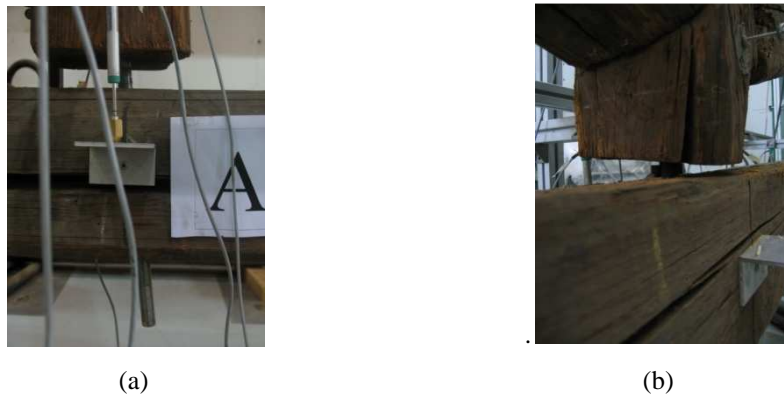
Figura 18 – Comportamento da ligação pendural-linha; (a) flexão do varão roscado no plano da asna; (b) flexão do varão roscado no plano ortogonal à asna.
