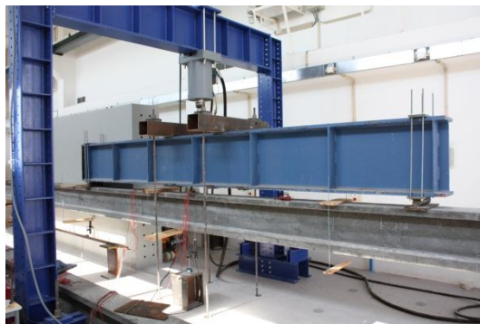
Figura 6 – Pré-carregamento e travamento da viga antes da operação de reforço.
