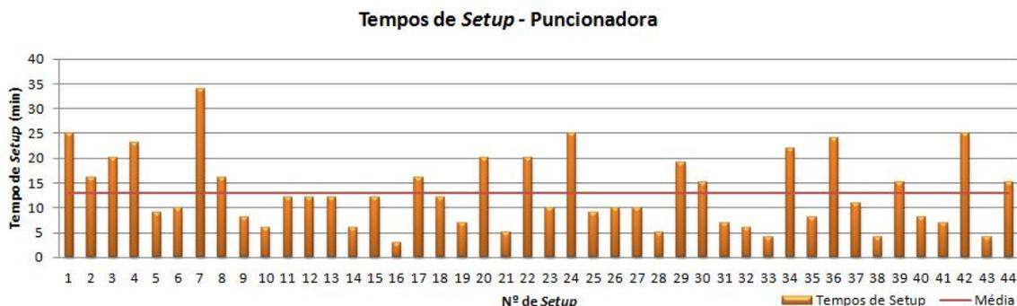
**Figura 31 - Tempos de *setup* registados pelo operador da puncionadora**
