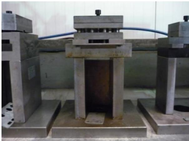
**Figura 24 - Molde utilizado na prensa**
