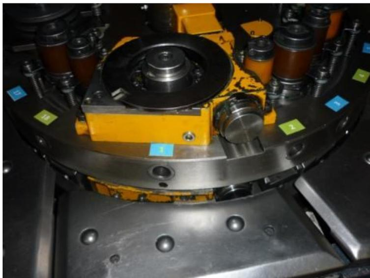
Figura 77 - Identificação das posições na torreta da puncionadora
