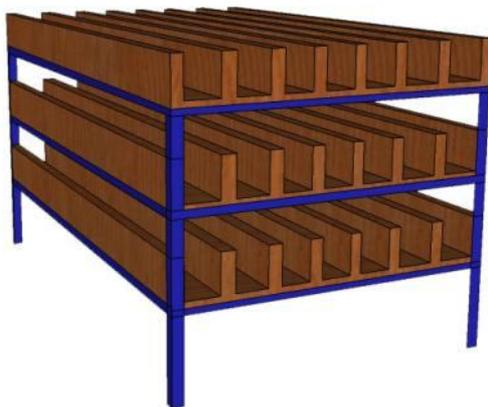
**Figura 83 - Desenho da solução para arrumação das ferramentas das quinadoras**
