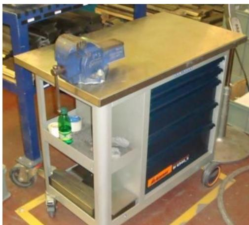
**Figura 67 - Revestimento em chapa e torno no novo carro de ferramentas**
