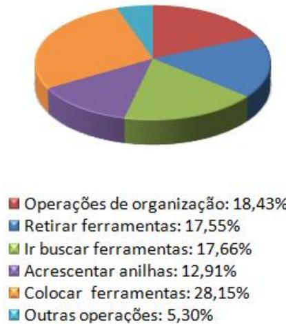
**Figura 73 - Percentagem de tempo gasto nos processos de *setup* da puncionadora**
