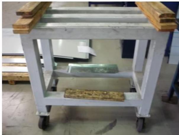
**Figura 82 - Nova banca para colocação de paletes das quinadoras**
