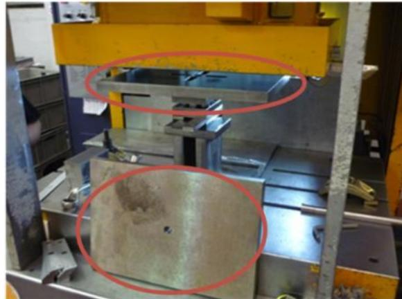
**Figura 56 - Duplicação da base superior dos moldes da prensa**
