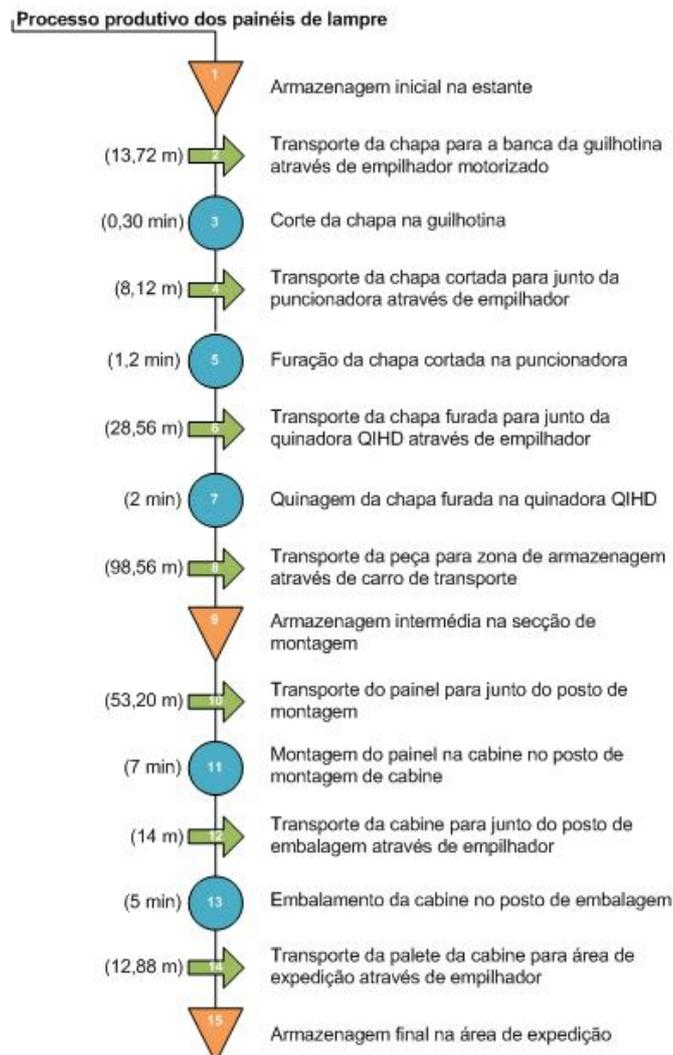
**Figura 42 - Diagrama de processo para o painel de cabine em lampre**
