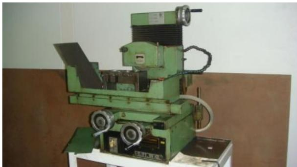
**Figura 72 - Retificadora de ferramentas da puncionadora**
