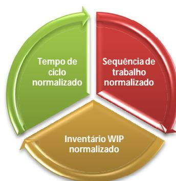
Figura 5 - Os três elementos chave do *Standard Work*
